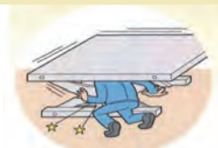
リフトテーブルに挟まれた
