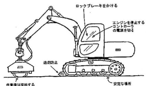
ただし、走行運転位置と作業運転位置が異なる場合で、作業装置の運転位置で運転し、または運転しようとしている場合は、逸走を防止する措置を講じさせてください。
